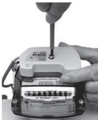
2) Screwing (Max torque: 0,25Nm)
